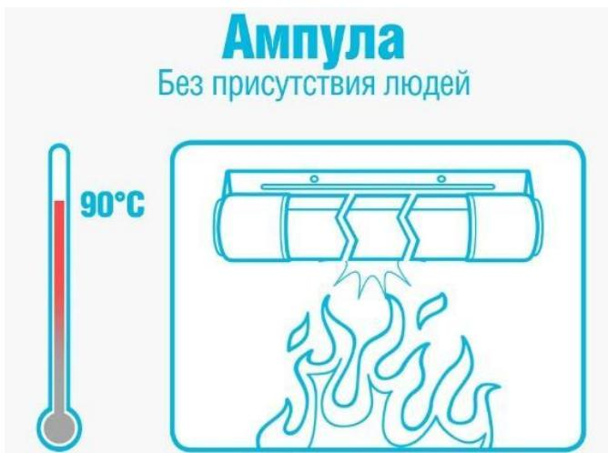
достижает 90 °C, ампула разрушается и распыляется содеримое над очагом возгорания. При этом большая часть жидкости переходит в газообразную фазу.
